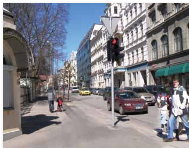
Luksofori uz gaismas emisijas diožu bāzes ļauj autovadītājam skaidri redzēt signālus arī spilgtā saules gaismā.
